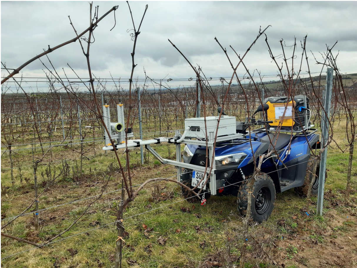
Abbildung 3: Das PhenoQuad mit der montierten Phenoboxx bei der Bildaufnahme des Winterholzes (vor dem Rebschnitt) im Winter 2021/2022.
